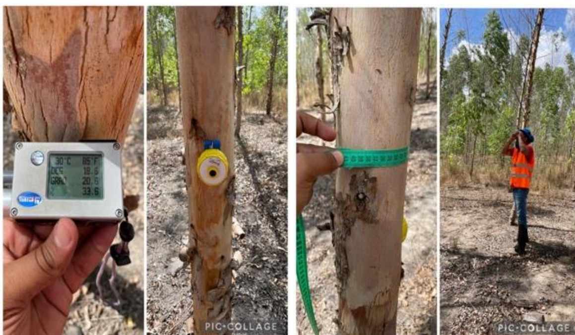
Figura 9. Calibração do dendrômetro Vertex IV e medição de CAP e altura dos indivíduos, em plantas de eucalipto na área experimento em Gloria do Goitá, Pernambuco, Brasil.
