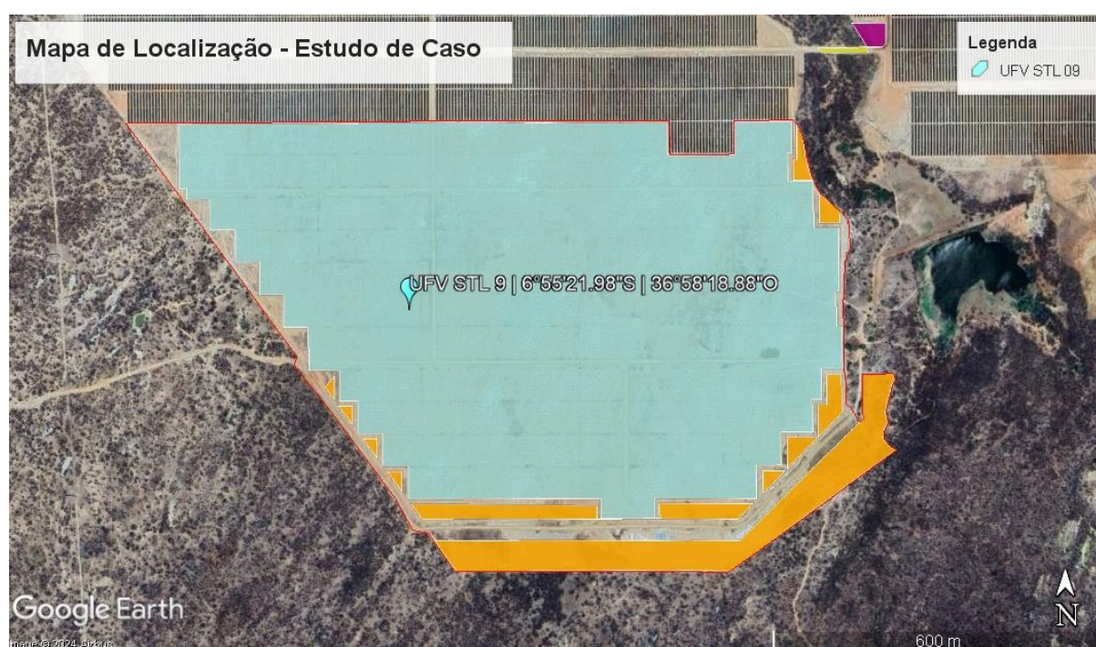
Figura 2 - Classificação das áreas utilizadas pela UFV STL 9. Em destaque: traçado em vermelho representa a área total de intervenção para implantação da usina; polígono em azul, a área efetiva da UFV; polígono em laranja, a área destinada à recuperação ambiental; áreas sem polígono correspondem às zonas de uso permanente da UFV.
