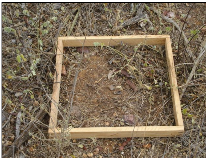
Figura 8. Imagem do molde vazado utilizado para coleta da serapilheira em uma área de caatinga no município de Floresta-PE, Brasil.
