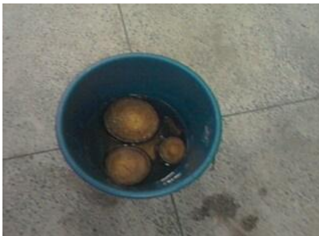
Figura 8. Discos de madeira imersos em água destilada no Laboratório de Dendrologia da Universidade Federal Rural de Pernambuco para saturação das fibras e posterior determinação de sua densidade.
