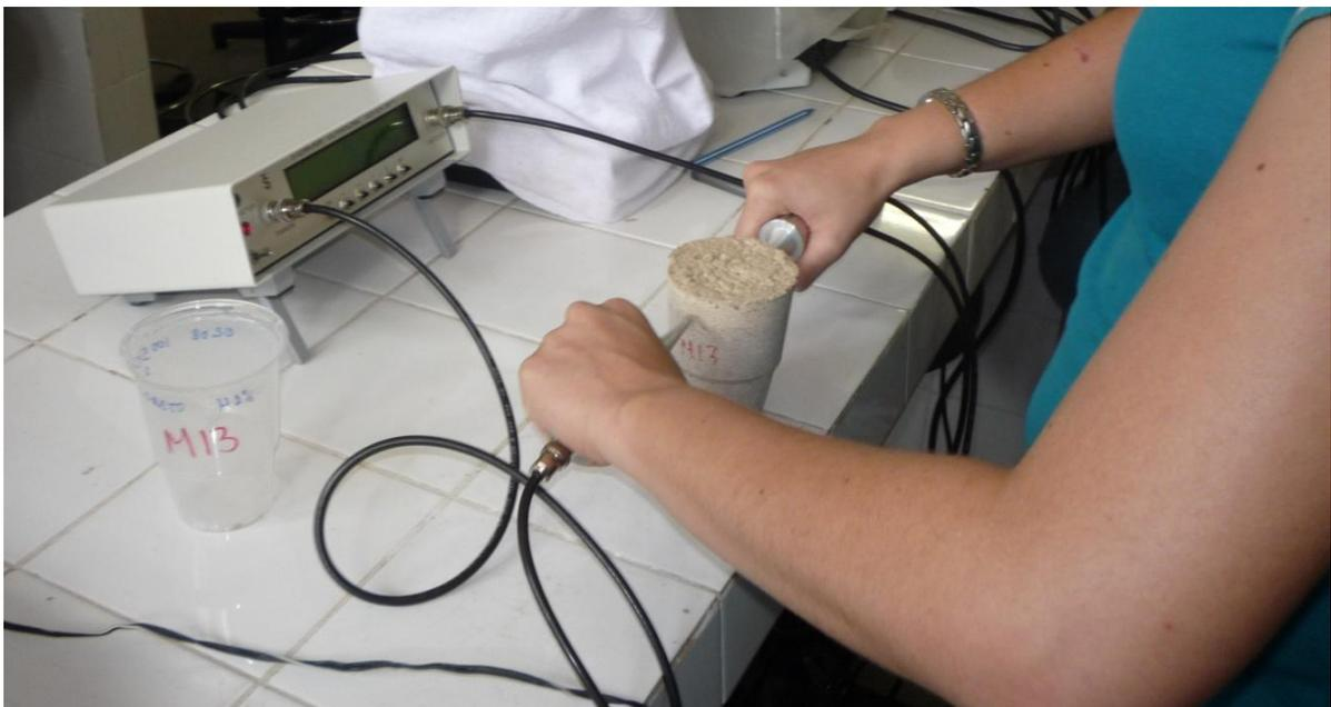
A velocidade do pulso ultrassônico ( $V_{pu}$ ) varia em função do tempo de vida dos corpos-de-prova (BERALDO e MARTINS, 2007), sendo um procedimento de avaliação das alterações produzidas na mistura enquanto ocorrem as reações de pega e endurecimento do compósito. A amplitude máxima da  $V_{pu}$  é considerada um indicador apropriado do grau de compatibilidade entre a madeira e o cimento, segundo Beraldo e Balzamo (2009).
