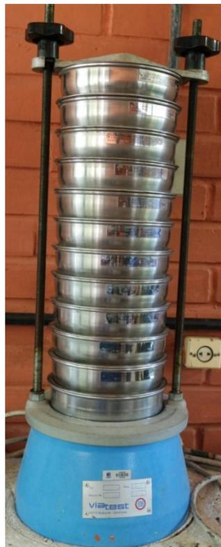
Foram coletados aleatoriamente 100 g de cada material seco ao ar e submetidos a ensaios no agitador. Conforme a NBR 7181:1988, o material deve ser peneirado até que menos de 1% passe por qualquer uma das peneiras.
