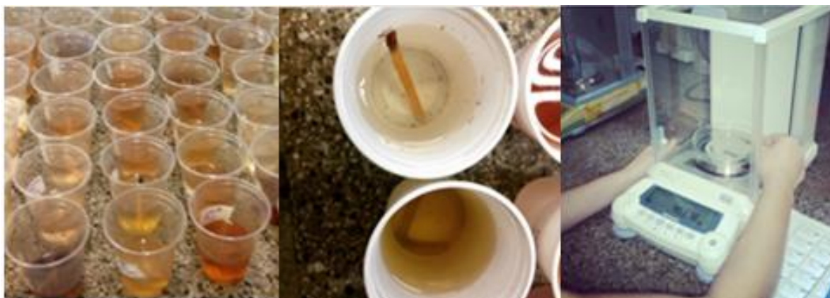
Figura 6. Etapas dos procedimentos para determinação da densidade de madeira
