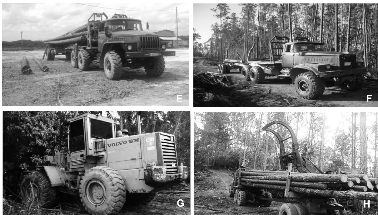
Figura 3 – Maquinaria de colheita e transporte florestal na EFI Macurije: A) Extração da madeira com o Skidder americano "John Deere 548E"; B) Skidder Chinês "J-80A". C) Junta de bois; D) Caminhão autocarregável KRAZ- 257; E) Caminhão URAL- 4320; F) Caminhão KAMAZ-4310; G) Carregador frontal "VOLVO BM L90B"; H) O carregador frontal "VOLVO BM L90B" carregando um caminhão URAL- 4320.
